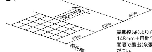
基準線(糸)より612mm(タイル148mm+目地5mmの4倍数)間隔で墨出(糸張り)を行ってください。
